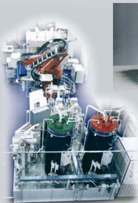
Profesionálně vyráběné vnější opláštění. Robot přesně nanáší směs látek (směs PU / skelné vlákno) na voštinovou strukturu.
